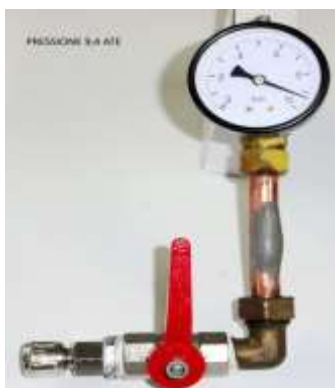
Tubo Rame Riparato Pressione At. 9,4
