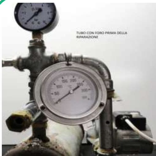
Tubo Ferro con foro Riparato e portato a Temperatura di 154° Gradi Atm 6,8
