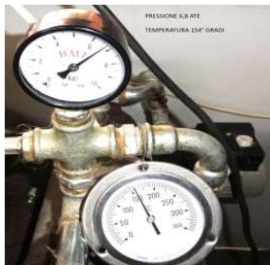
Tubo Ferro con foro Riparato e portato a Temperatura di 154° Gradi Atm 6,8
