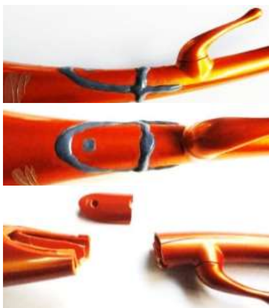
Riparazione di un manico in plastica Di una scopa elettrica
